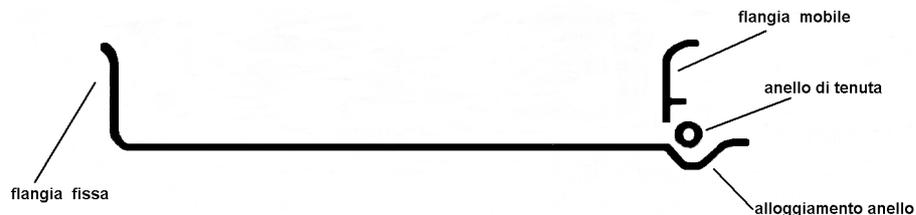
l'operazione deve iniziare con lo smontaggio dell'anello di tenuta e della flangia mobile. L'operatore deve sempre evitare di trovarsi di fronte alla ruota e sulla traiettoria degli elementi del cerchio scomponibile che potrebbero schizzare via nel caso la ruota fosse danneggiata.
